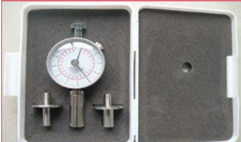
مقياس «سليروميتر» Sclerometer هو بديل سلم موهس في إعطاء الدقة المطلوبة
