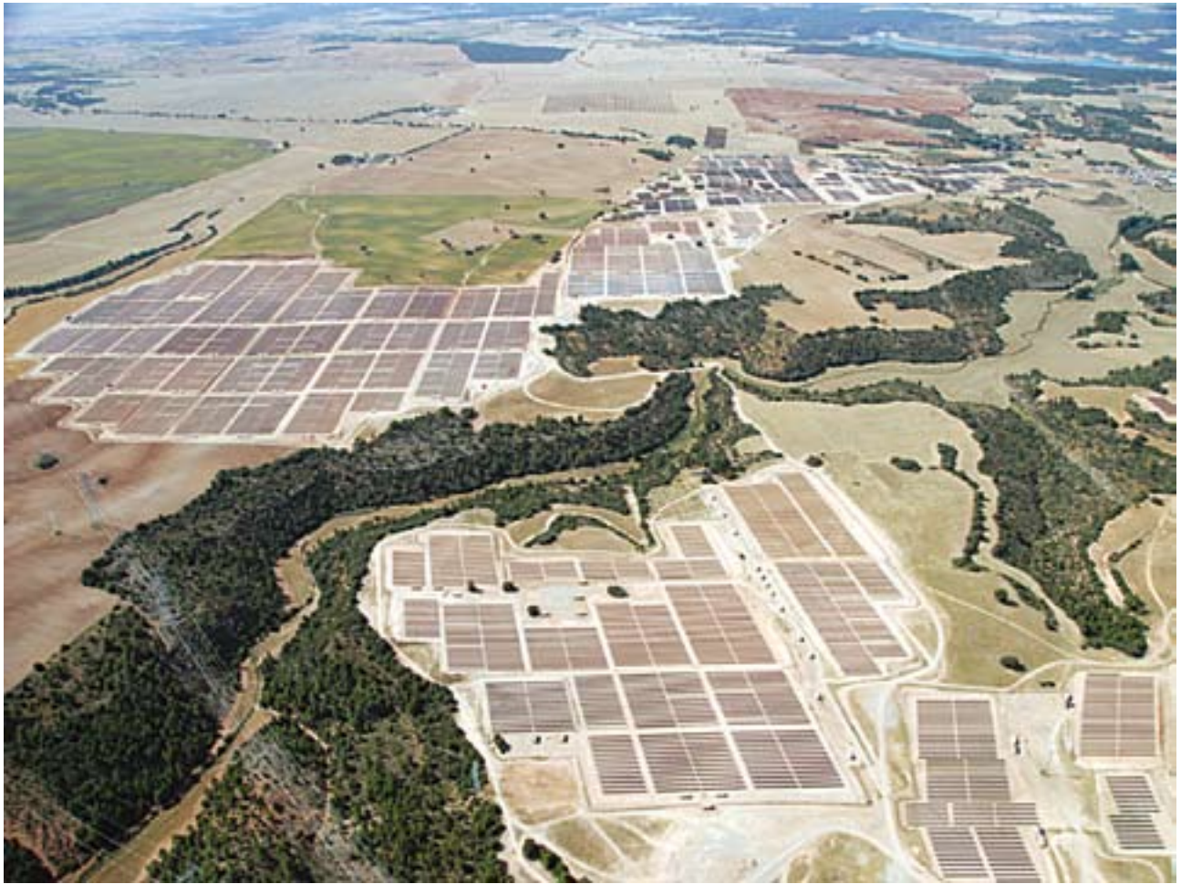
الشكل (1) تعدد حديقة الخلايا الفوتوفولطية في أولميديا دو الأرنون في إسبانيا من أكبر الحدائق في العالم حيث يبلغ عدد الألواح الشمسية 162 ألف لوح تغطي مساحة قدرها 130 هكتاراً (1.3 مليون متر مربع). وقد بلغت تكلفة تشييد هذه الحديقة نحو 350 مليون دولار.
