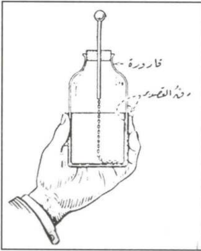
شكل رقم (١٥٥) : قارورة ليدن - وهي شكل بدائي للمكثف الذي استخدمه فرانكلين في تجاربه عن الكهرباء
